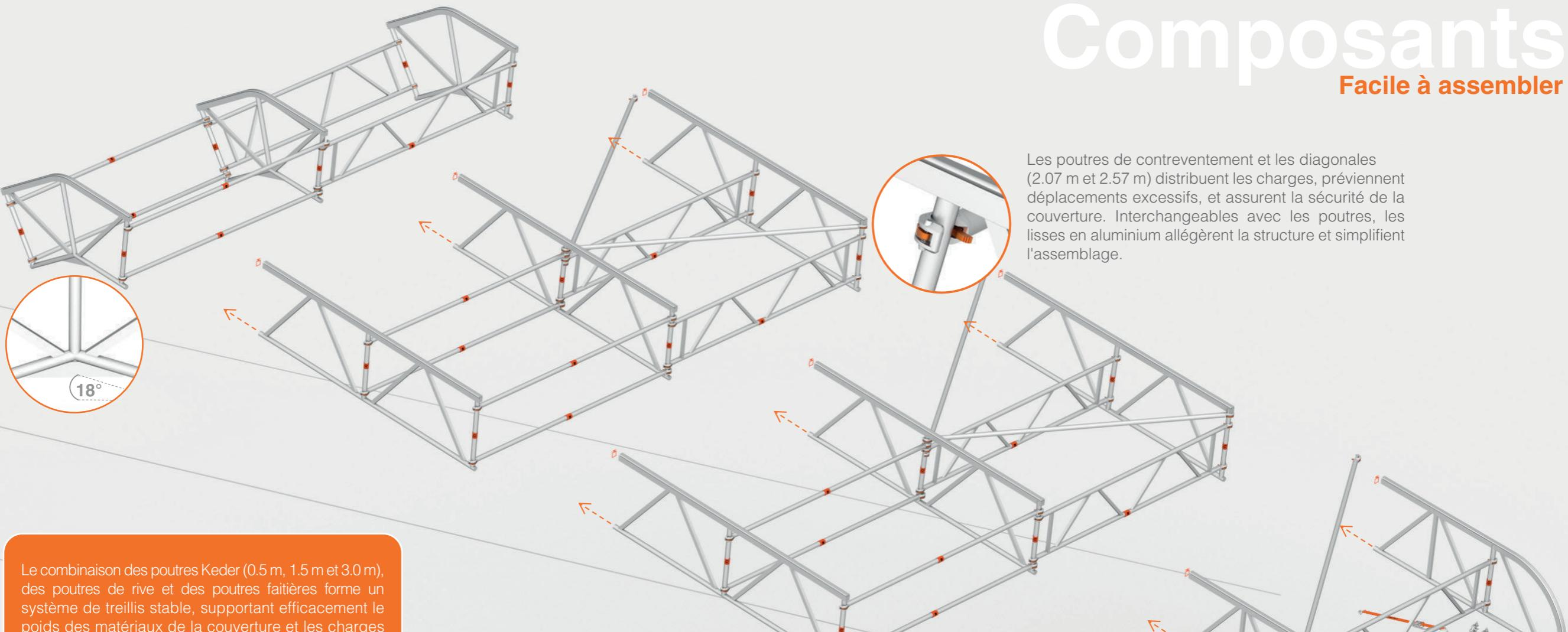
Le combinacion des poutres Keder (0.5 m, 1.5 m et 3.0 m), des poutres de rive et des poutres faitières forme un système de treillis stable, supportant efficacement le poids des matériaux de la couverture et les charges supplémentaires, tels que le vent, la neige et les équipements, en les distribuant efficacement pour la structure portante.
